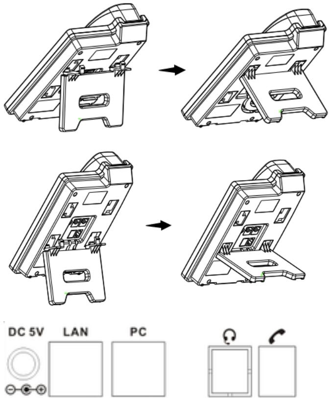
安装支架: 将支架的卡扣对准支架板下面两个卡口后, 手托住支架向上轻轻推一下即可. (如上图)
